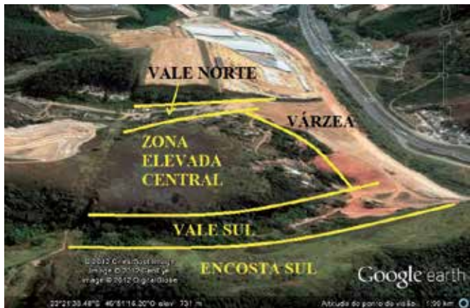
Figura 15 – Gleba a ser ocupada por futuro grande empreendimento logístico cuja setorização geomorfológica inicial orientou as investigações e confirmou a maior concentração de vazios cársticos nas zonas baixas do Vale Norte, do Vale Sul e da Várzea
