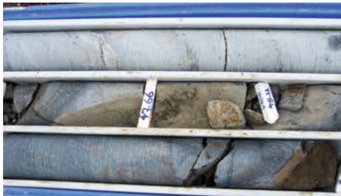
Figura 7 – Testemunhos de sondagem rotativa mostrando fraturas abertas com sinais de dissolução na zona superior do maciço calcário são
