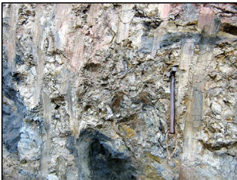
Fig 10 - Detalhe da zona de interface solo/rocha brechóide argilosa e cárstica. Foto ARSantos.
