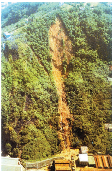
Escorregamento planar raso típico da Serra do Mar. Notar a proximidade da "raiz" do escorregamento da crista do espigão. (Foto do Autor)
