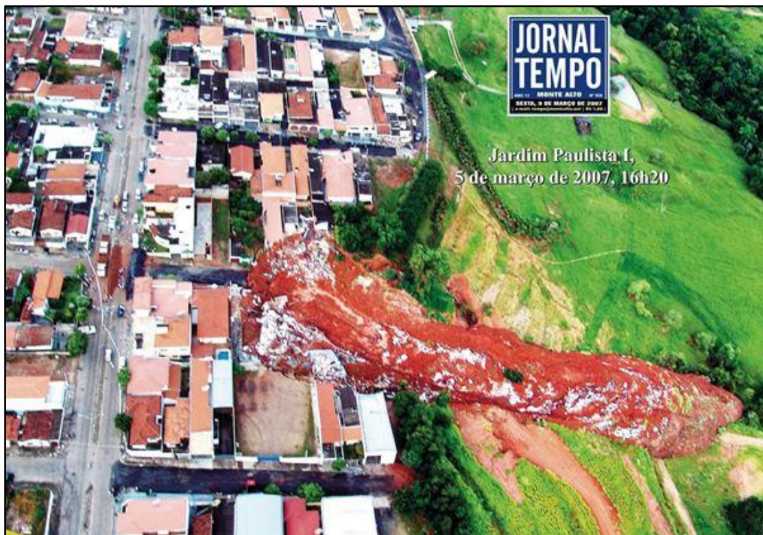
Bossoroça, que teve sua "cabeça" aterrada para receber ocupação urbana, reativada pela concentração de fluxos de água profundos e superficiais. Monte Alto SP. Foto Jornal Tempo.
