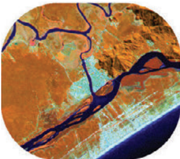
Imagem Landsat da região de Iguape (litoral paulista) mostrando o canal artificial (Valo Grande) ligando o rio Ribeira de Iguape diretamente com o Mar Pequeno. Notar a extensão dos bancos de assoreamento que se instalaram, inclusive inutilizando o Porto de Iguape. (Foto edição Nivaldo Paulon)
