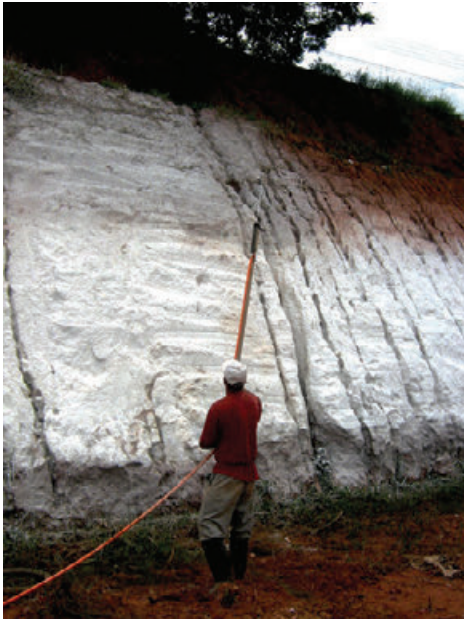
A lança presa em uma haste de madeira leve como expediente para se atingir alturas maiores. (Foto do Autor)
