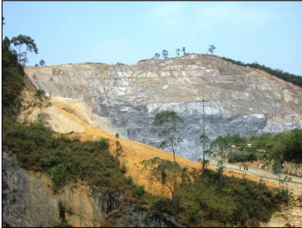
Fig 5 - Frentes típicas de pedreiras de calcário no município de Cajamar - SP, mostrando o maciço compacto, sem a presença de figuras clássicas de dissolução. Foto ARSantos.
