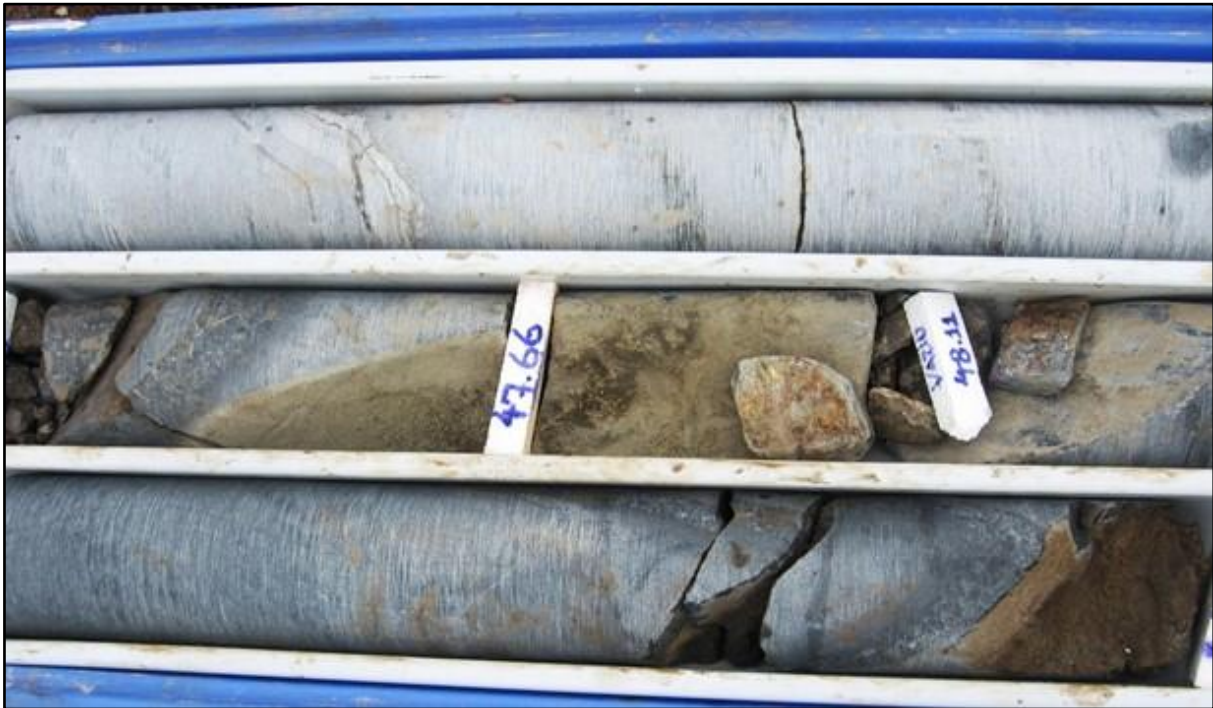
Fig 7 - Testemunhos de sondagem rotativa mostrando fraturas abertas com sinais de dissolução na zona superior do maciço calcário são. Foto ARSantos.
