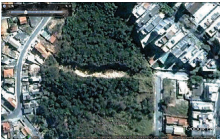
Figura 1 – Imagem aérea de julho de 2006 mostrando as dimensões da ravina de erosão em evolução para um processo de emboçoracamento. (Foto Google Earth)
