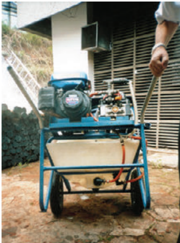
O equipamento de pulverização motorizada: motor 4 tempos a gasolina, bomba hidráulica de membrana e tanque misturador. (Foto do Autor)
